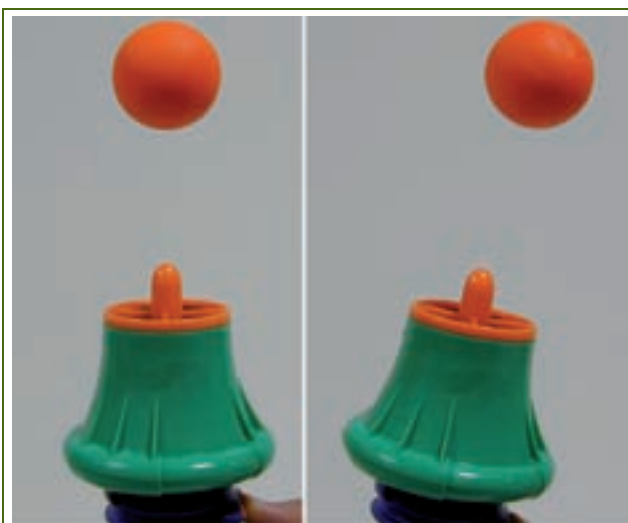
Figura 14. Bola flotante en flujo de aire. Una esfera ligera, pintada de color naranja, flota en el flujo de aire producido por un ventilador dotado de rejilla. Si el eje del flujo de aire se inclina, la bola se separa de la vertical y sigue al flujo de aire hasta que, para un cierto ángulo de inclinación, la bola cae en vertical. Este comportamiento brusco se puede describir también como una catástrofe en pliegue .
