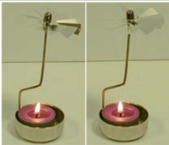
Figura 15. Molinete térmico. Apoyado sobre una punta, el aire caliente ascendente golpea sus álabes, cuya inclinación respecto de la vertical permite que, por reacción, se produzca el par de fuerzas que lo hace girar.
