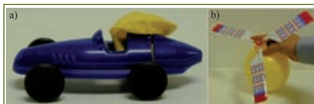
Figura 9. (a) Coche movido por globo . Vehículo movido por un globo hinchado unido a él que se deshinch a través de un orificio. (b) Helicóptero de globo . El giro del helicóptero es producido por el globo al deshincharse a través de un distribuidor que envía el aire a través de sus alas, con contienen un tubo hueco con un codo. Para permitirle ascender, sus alas tienen una cierta inclinación respecto de la horizontal.
