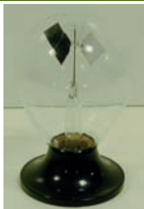
Figura 17. Radiómetro de Crookes. El radiómetro no funciona debido a la presión de radiación, la idea original de Crookes al construirlo, sino debido a un mecanismo de choques contra los bordes de los rombos, por lo que se necesita una pequeña cantidad de aire a baja presión. Si hubiera demasiado aire, el rozamiento haría que se detuviera el giro de las paletas.
