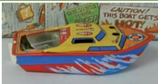
Figura 19. Barco "chop-chop" . El vapor producido por el calentamiento del agua en el interior del depósito dotado de una pequeña placa vibrante expulsa el agua de los tubos y, al enfriarse, vuelve a permitir la entrada de nueva agua, que al volver a evaporarse, cierra el ciclo térmico.
