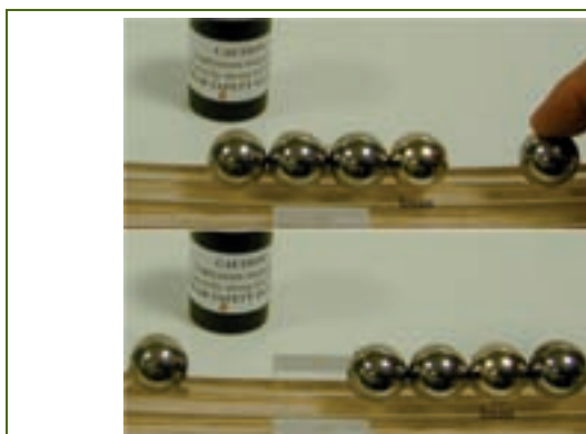
Figura 22. Cañón de Gauss . Cuatro bolas de acero, la cuarta es un imán de neodimio-boro-hierro, se colocan sobre un carril. Se deja libre una quinta bola, que es atraída por el imán. La primera bola sale despedida a gran velocidad, alcanza una altura importante y el restante conjunto de cuatro bolas, se desplaza moviéndose en sentido contrario (Tercera Ley de Newton).
