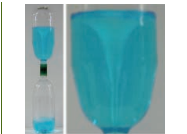
Figura 11. Tornado en una botella. Un tapón de doble rosca permite unir dos botellas, una de ellas casi llena de agua. Con el agua en la botella superior, al proporcionarle un movimiento de rotación, se forma un tornado y el agua comienza a descender por las paredes de la botella y el aire a ascender por el ojo del tornado.
