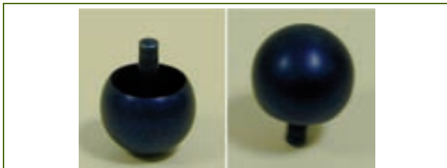
Figura 3. Tip-Top . Cuando esta peonza se ha invertido y gira sobre su vástago, la velocidad de rotación es menor que la velocidad de rotación cuando gira sobre la base esférica, pues al elevar su centro de gravedad parte de la energía cinética de rotación se ha invertido en energía potencial gravitatoria.
