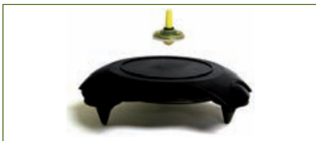
Figura 6. Levitrón (cortesía de ThinkGeek, www.thinkgeek.com ). Una pequeña peonza, bien equilibrada mediante pequeñas arandelas, se estabiliza por rotación y levita sobre el campo magnético complejo creado por una particular disposición de imanes ocultos en la base del aparato.
