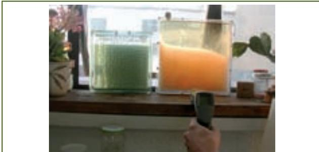
**Figura 1.** Vista de dos acumuladores de cambio de fase, el verde, no fundido, de 20°C, el marrón anaranjado, en proceso de fusión de 10°C.
