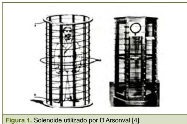
Figura 1. Solenoide utilizado por D'Arsonval [4].
