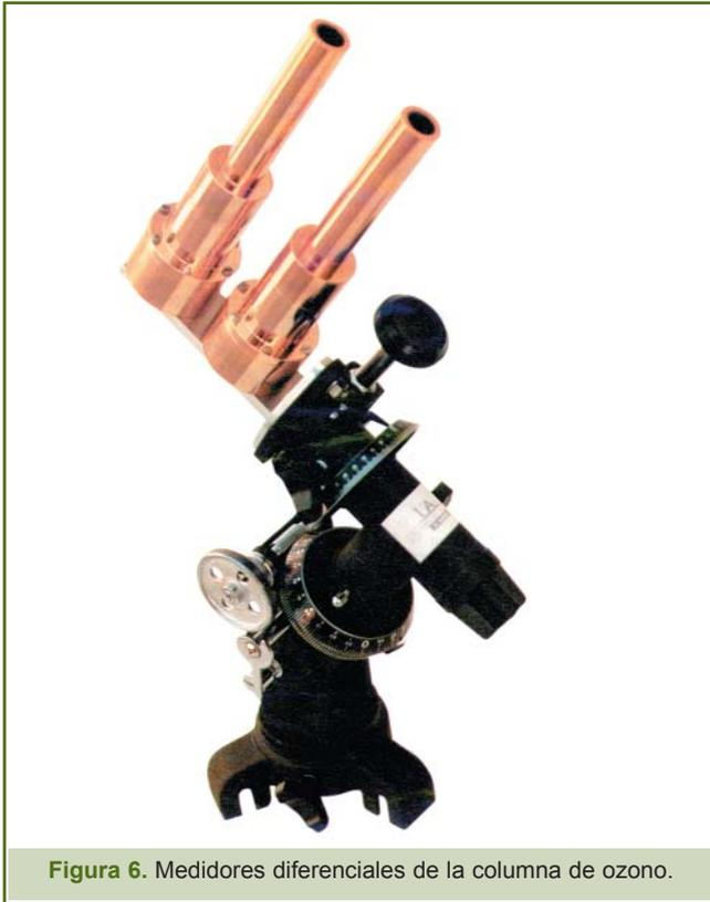
Figura 6. Medidores diferenciales de la columna de ozono.
