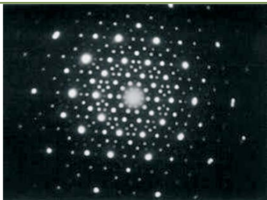
Foto 1. Patrón de difracción de un cuasicristal de Aluminio-Manganeso, elaborado en el Instituto de Física de la UNAM. Foto: cortesía de José Reyes Gasga.
