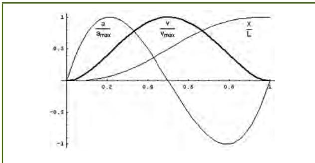
**Figura 2.** Funciones velocidad, aceleración y espacio recorrido correspondientes al viaje con menor grado de aceleración: ecuaciones (3a), (3b) y (3c). En abscisas, el tiempo está medido en unidades de la duración,  $T$ , del viaje.
