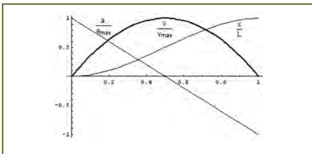
**Figura 1.** Funciones velocidad, aceleración y espacio recorrido correspondientes al viaje con menor grado de aceleración: ecuaciones (2a), (2b) y (2c). En abscisas, el tiempo está medido en unidades de la duración,  $T$ , del viaje.
